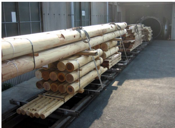
図 6.8 加圧処理法による木材の薬剤処理
