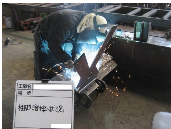
図 18.8 柱脚金物の溶接
