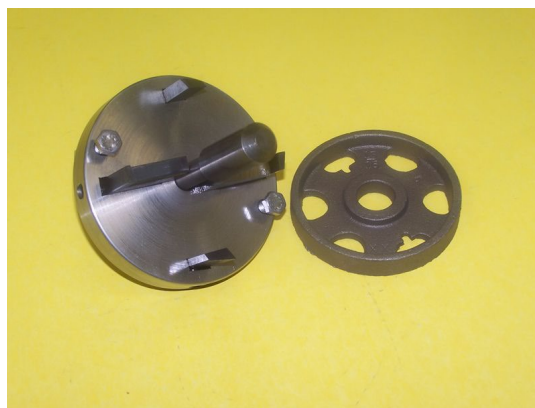
図 17.4 シアプレートと彫り込み加工具
