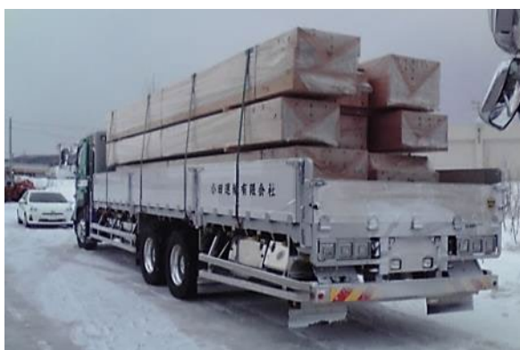
図 22.4 荷崩れを防止する処置
