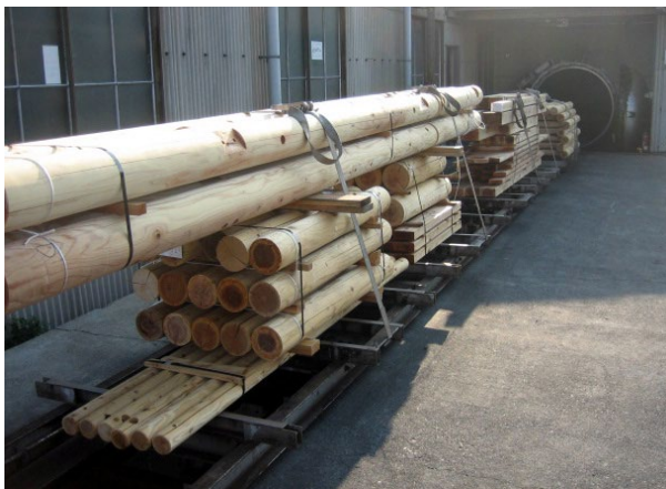
図 6.8 加圧処理法による木材の薬剤処理
