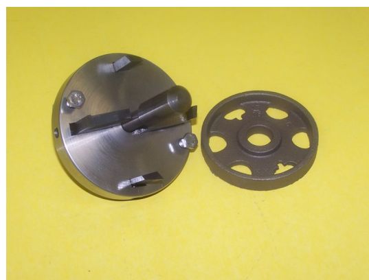
図 17.4 シアプレートと彫り込み加工具
