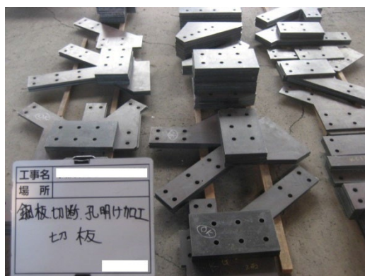
図 18.4 切断孔あけ後の切板
